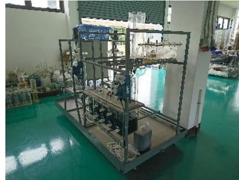
ABR (2-stage digestion) 20 L/day
